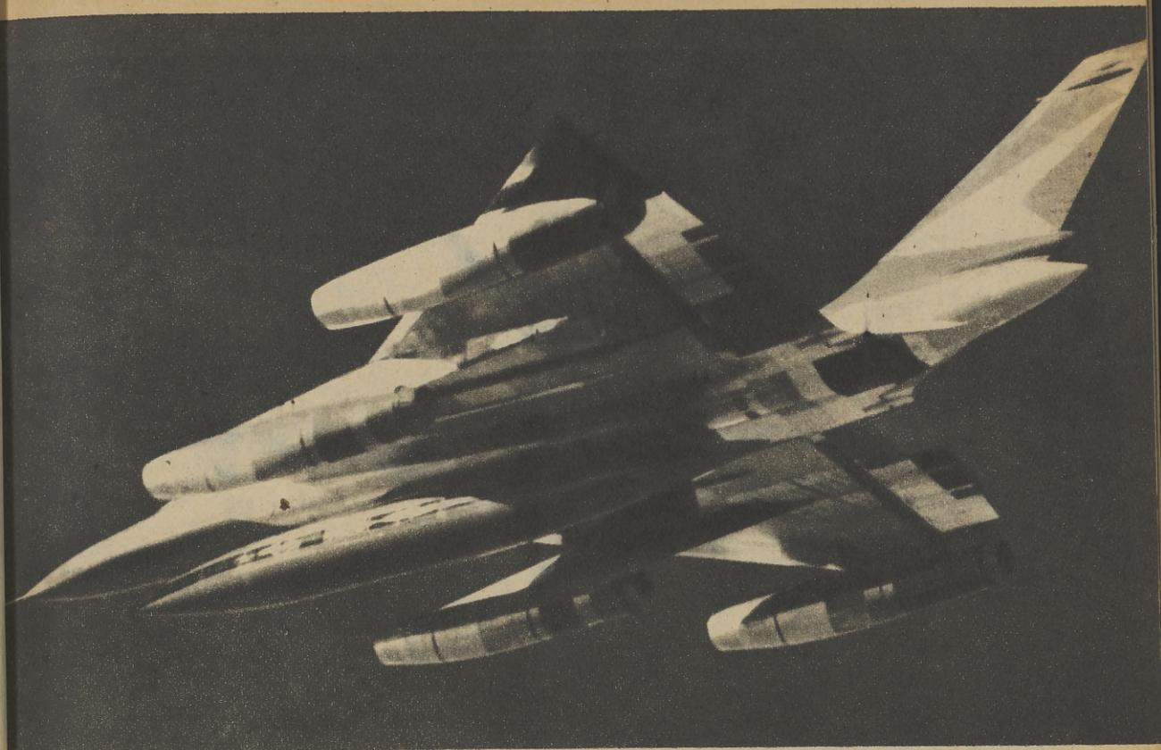
Más de dos mil kilómetros por hora alcanza el "Hustler B-58", de fabricación norteamericana. Lleva una bomba nuclear en una capsula debajo del fuselaje
