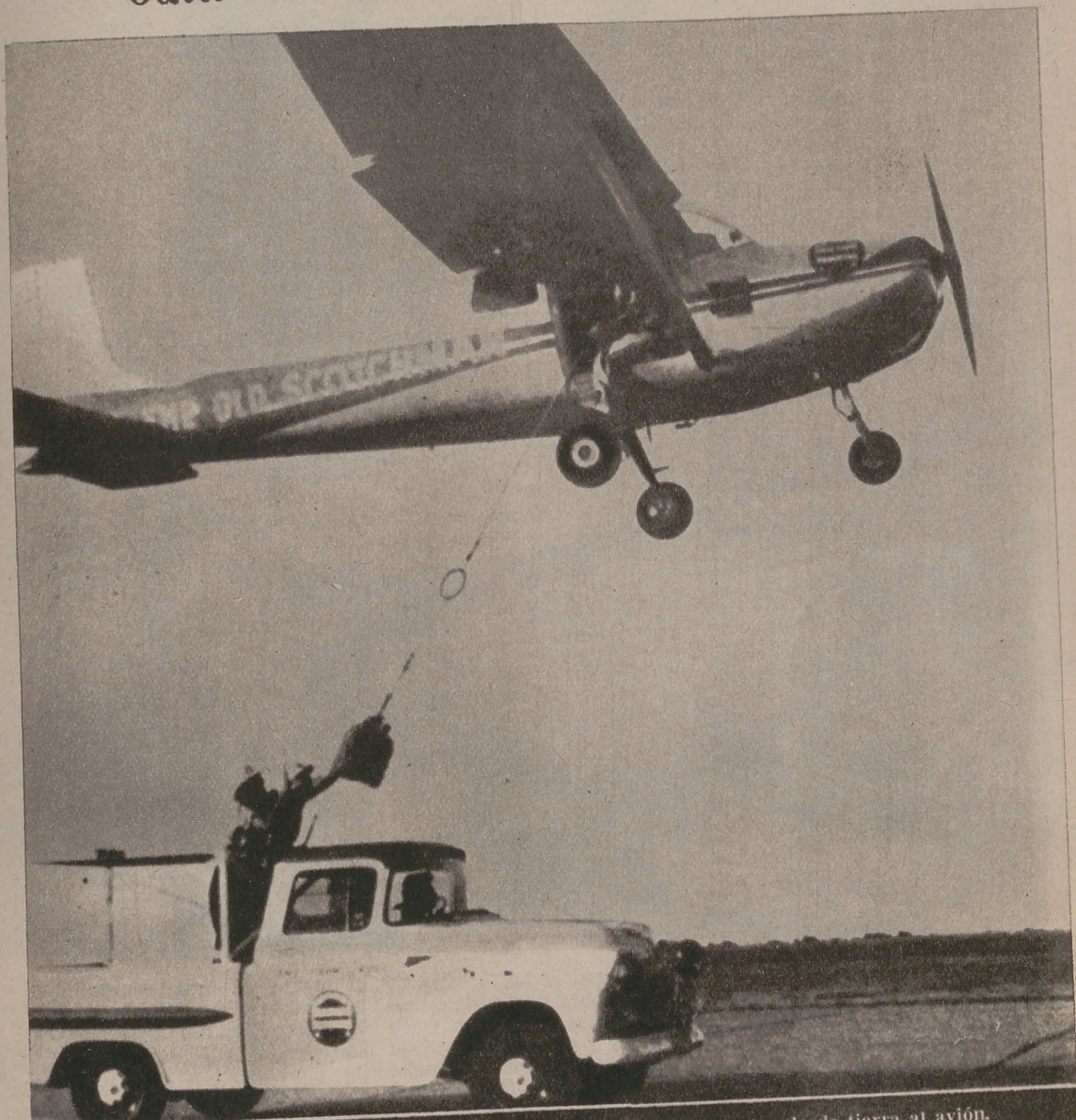
Para el éxito de la prueba de duración de vuelo fue necesario repostar desde tierra al avión. He aquí un momento de dicha operación
