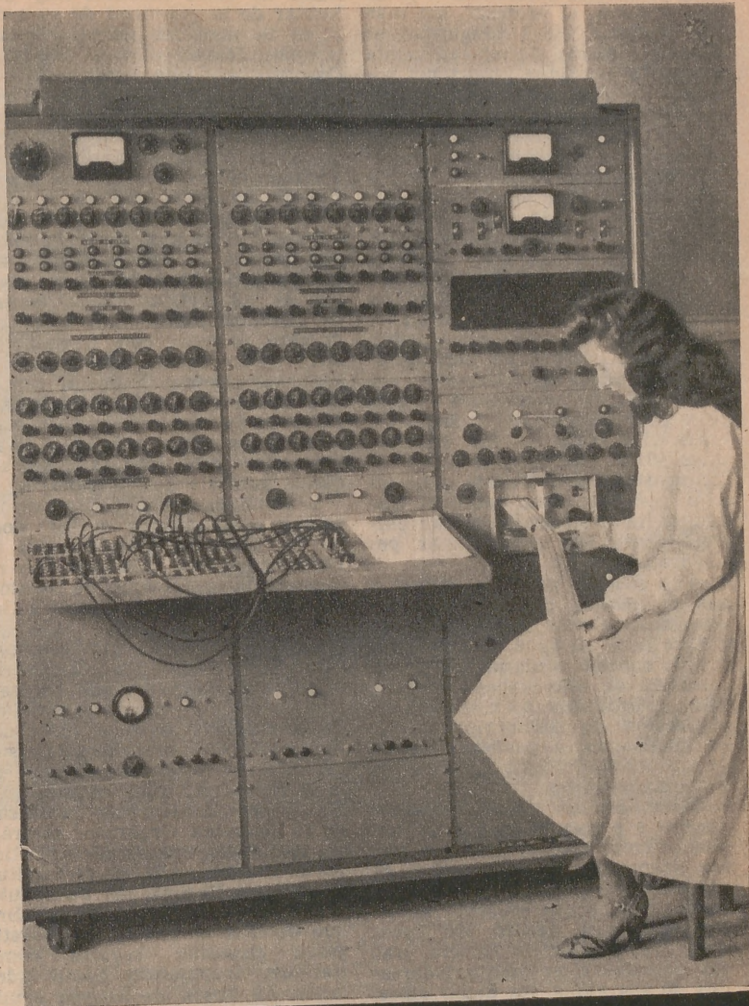
Analizador Diferencial Electrónico, construido en el Instituto de Electricidad del C. S. I. C.
