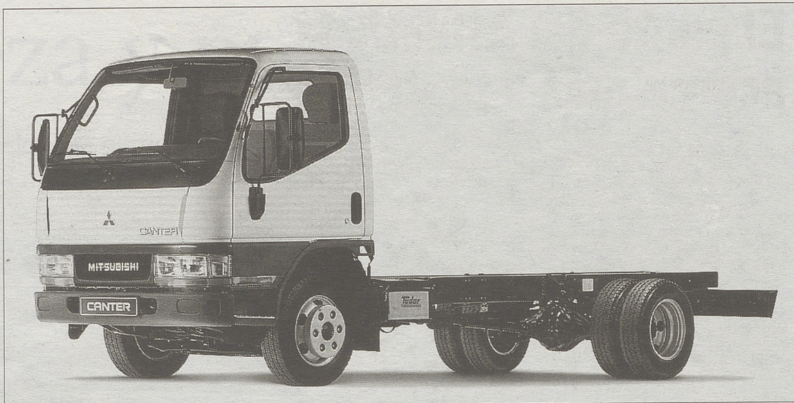
El motor del nuevo Canter de hasta 3,5 toneladas, tiene una cilindrada de 2.977 centímetros cúbicos y desarrolla 125 caballos.
