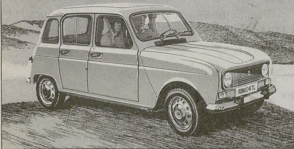
Si usted tuviera un Renault 4, todos los caminos serían buenos: llevaría una suspensión por barras de torsión independiente a las cuatro ruedas e iría con el suelo del coche a 18 centímetros del terreno. Y llevaría hasta 1.185 dm<sup>3</sup> de equipaje al fin del mundo gracias a su robusto motor de 852 cm<sup>3</sup> y tracción delantera.
