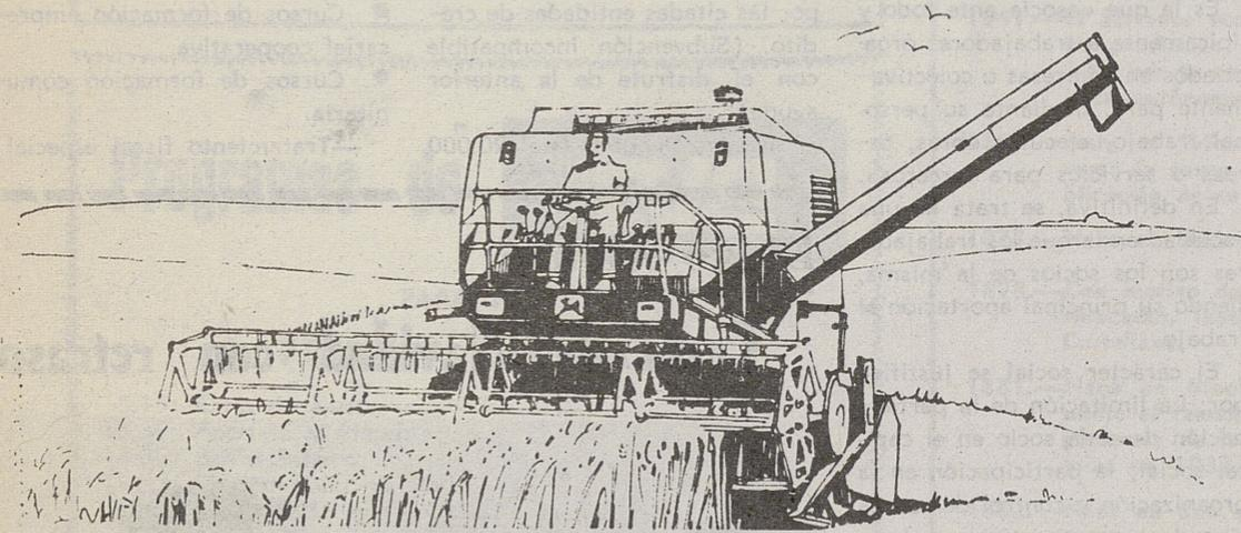
Los motores de las cosechadoras John Deere 975 y 965 con 150 y 125 CV DIN respectivamente están diseñadas para dar todo el rendimiento tanto bajo el sofocante calor del verano como en la campaña del maíz.
