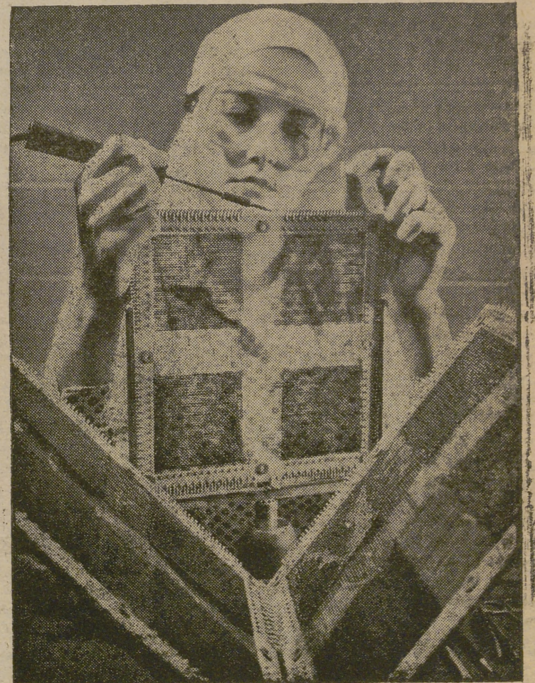
TEJEDOR DE MEMORIA.—Esta señorita, especializada en electrónica está tejiendo un plano memorizador para un cerebro electrónico. Dicho plano, se combina con otros 13, acumulando antecedentes para el sistema electrónico, para resolver a grandes velocidades los problemas más complejos.
