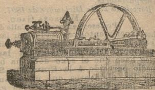
Máquina de vapor fija horizontal.
