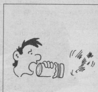
Emite sonidos en la parte abierta del tubo (¡Aaa!). Las vibraciones de la voz harán moverse a la membrana y al espejo, cuyo reflejo vibrará, produciendo figuras luminosas en la pared de enfrente.
