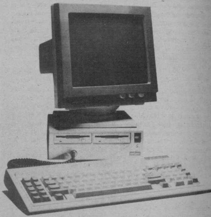
Inves PC-X10 con memoria RAM de 512 E Kb, velocidad seleccionable entre 4,77 y 10 Mhz y sistema operativo Ms-DOS 3.2 y GW-Basic 3.2.— (Foto Efe)
