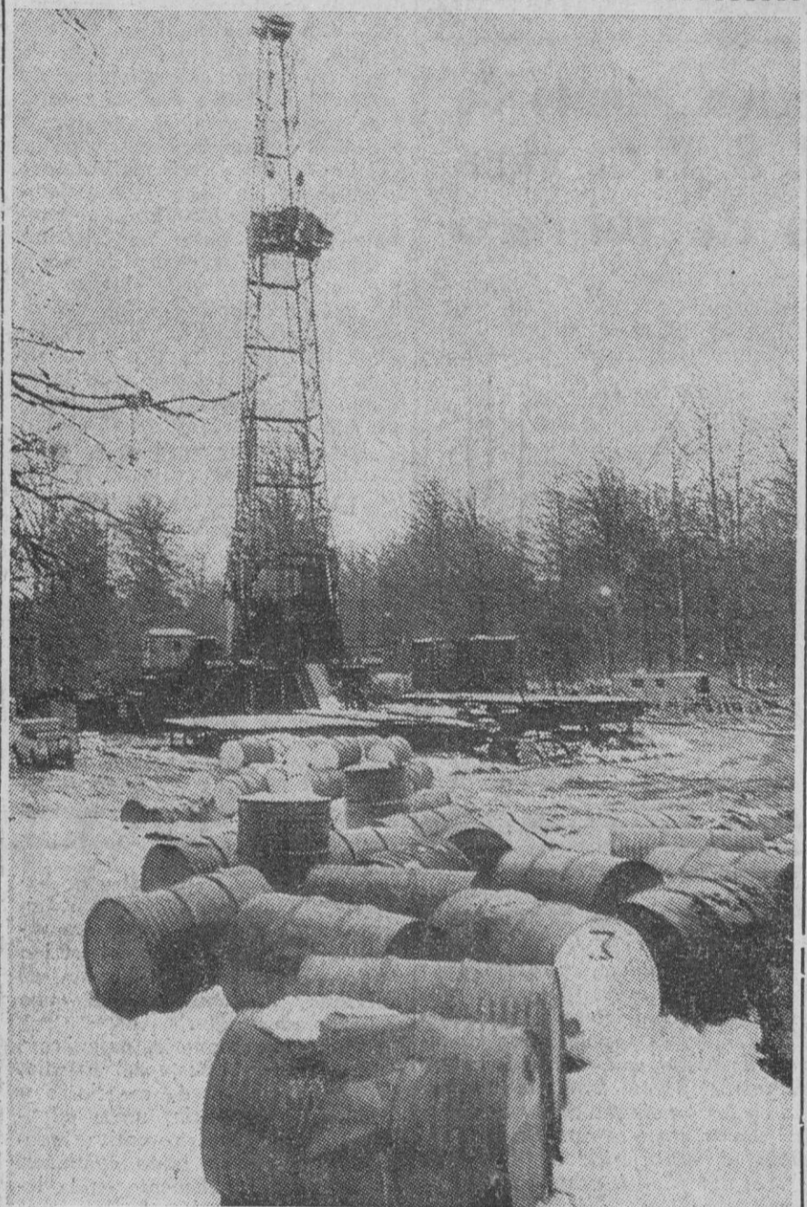
Urbasa.—La fotografía muestra las instalaciones de las prospecciones que se llevan a cabo en la Sierra de Urbasa, donde se han perforado cerca de tres mil metros. Aunque el resultado permanece en el más riguroso secreto, parece ser que el gas obtenido abriga esperanzas de "algo más".
