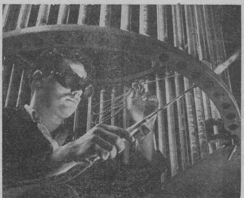
Soldadura de elementos tubulares de horno eléctrico para templar metales, en una fábrica de Birmingham, donde se produce equipo eléctrico con destino a diversos países del mundo.
