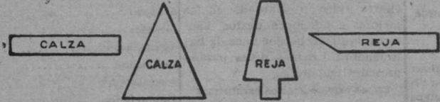
RECORTES Y PLETINAS PARA FABRICACIÓN DE HERRADURAS
