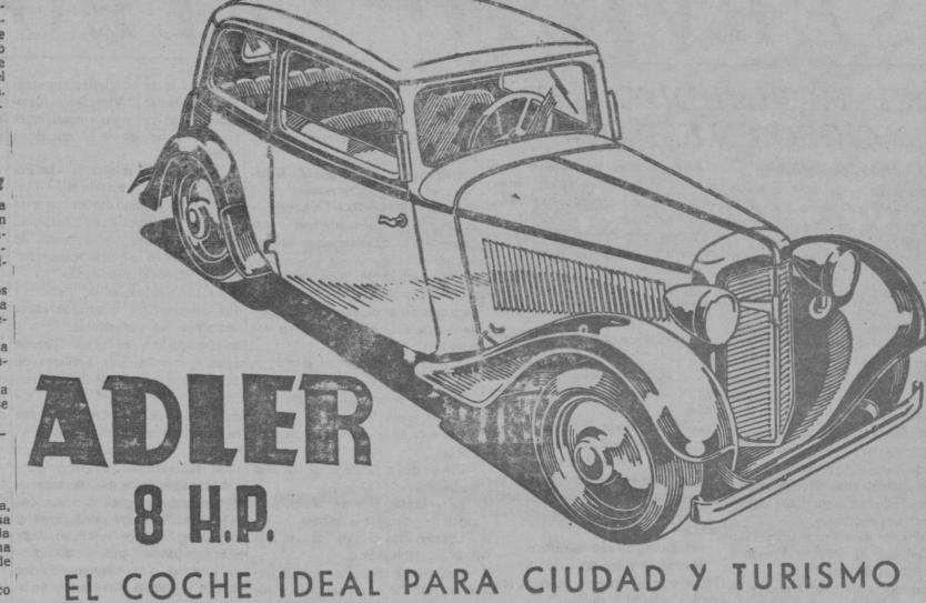
Un coche económico en todos sus aspectos Tracción delantera Cuatro ruedas independientes Cambio sincronizado con cinco marchas en el árbol de la dirección Amortiguadores hidráulicos O Consumo 7 1/2 litros por 100 kilómetros. Adherencia perfecta a la carretera debido a su bajo centro de gravedad Amplias carrocerías descapotables, con maleta trasera O Potencia fiscal 8 H. P. Vetocidad 100 kilómetros p. h.
