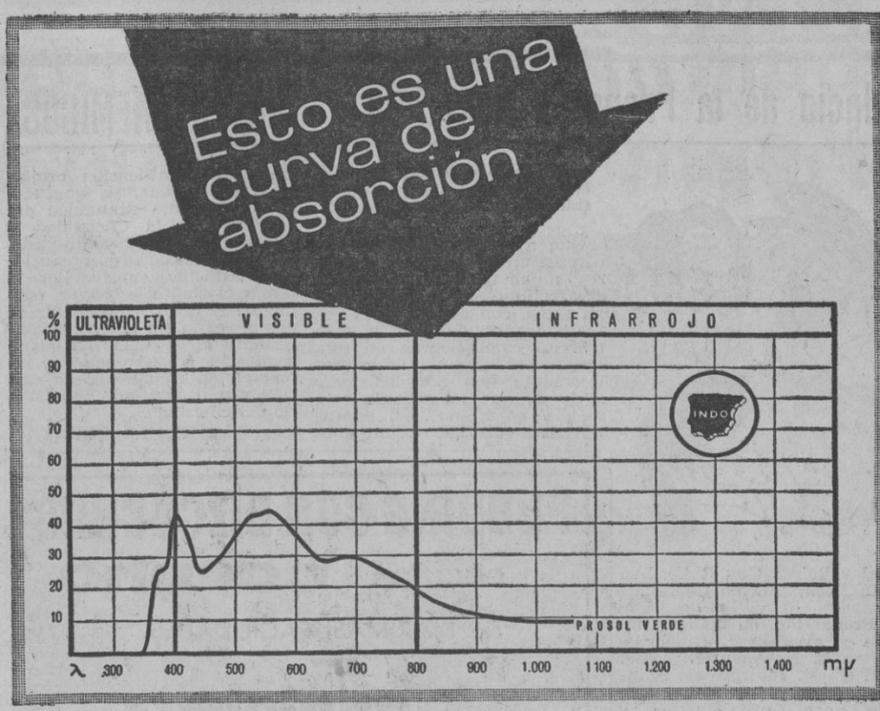
Una curva de absorción es como el "carnet de identidad" de los vidrios de color. Mediante un delicado y preciso instrumento científico -el espectrofotómetro-, se determinan, de forma gráfica y exacta, las propiedades absorbentes de los vidrios.
