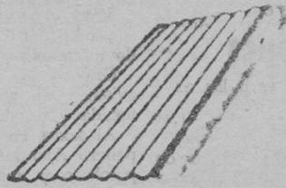
Sovedilas patentadas para la construcción de techos
