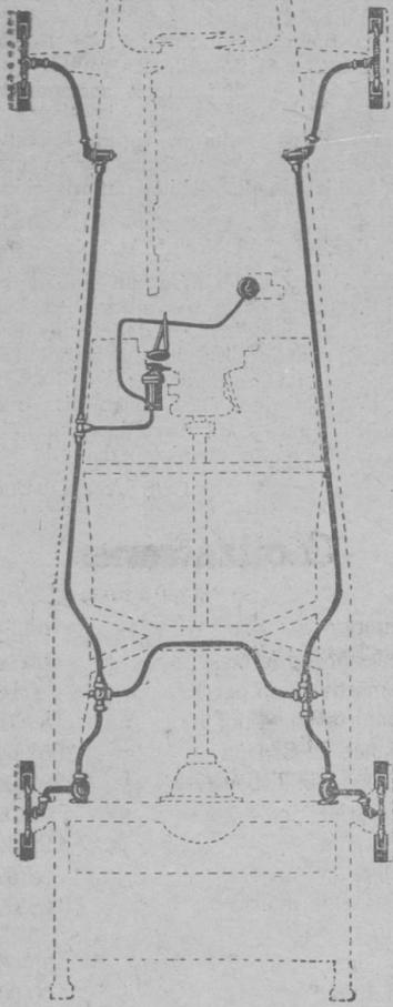
Diseño de un chasis Paige Jewett de frenos hidráulicos 4 ruedas, ataque directo sin conexiones ni muelles, careciendo en absoluto de puntos que deban engrasarse
