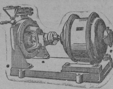
para elevación de agua y de accionamiento eléctrico
