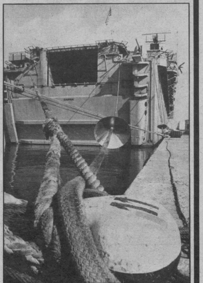
Compuerta de popa que da acceso al dique interior inundable donde se transportan las lanchas de desembarco
