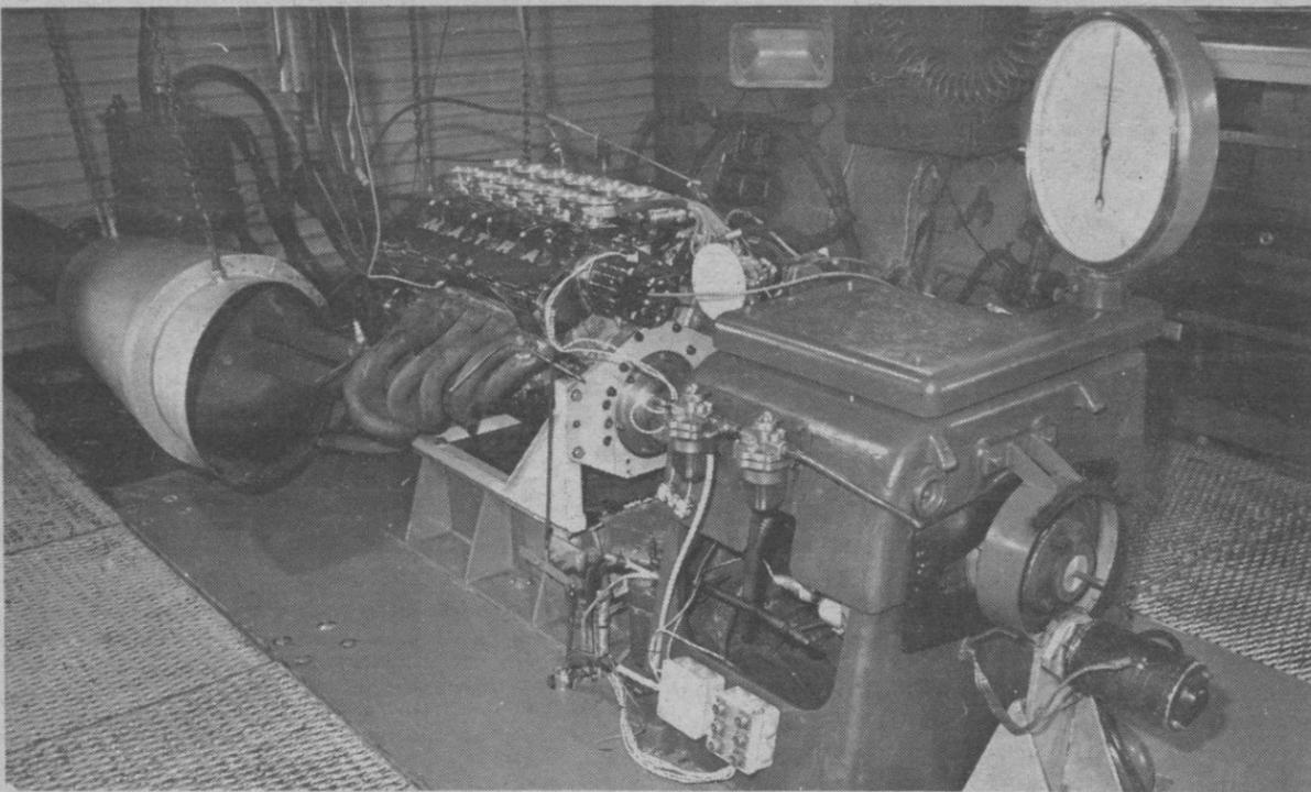
El motor de 12 cilindros en V, en el banco de pruebas
