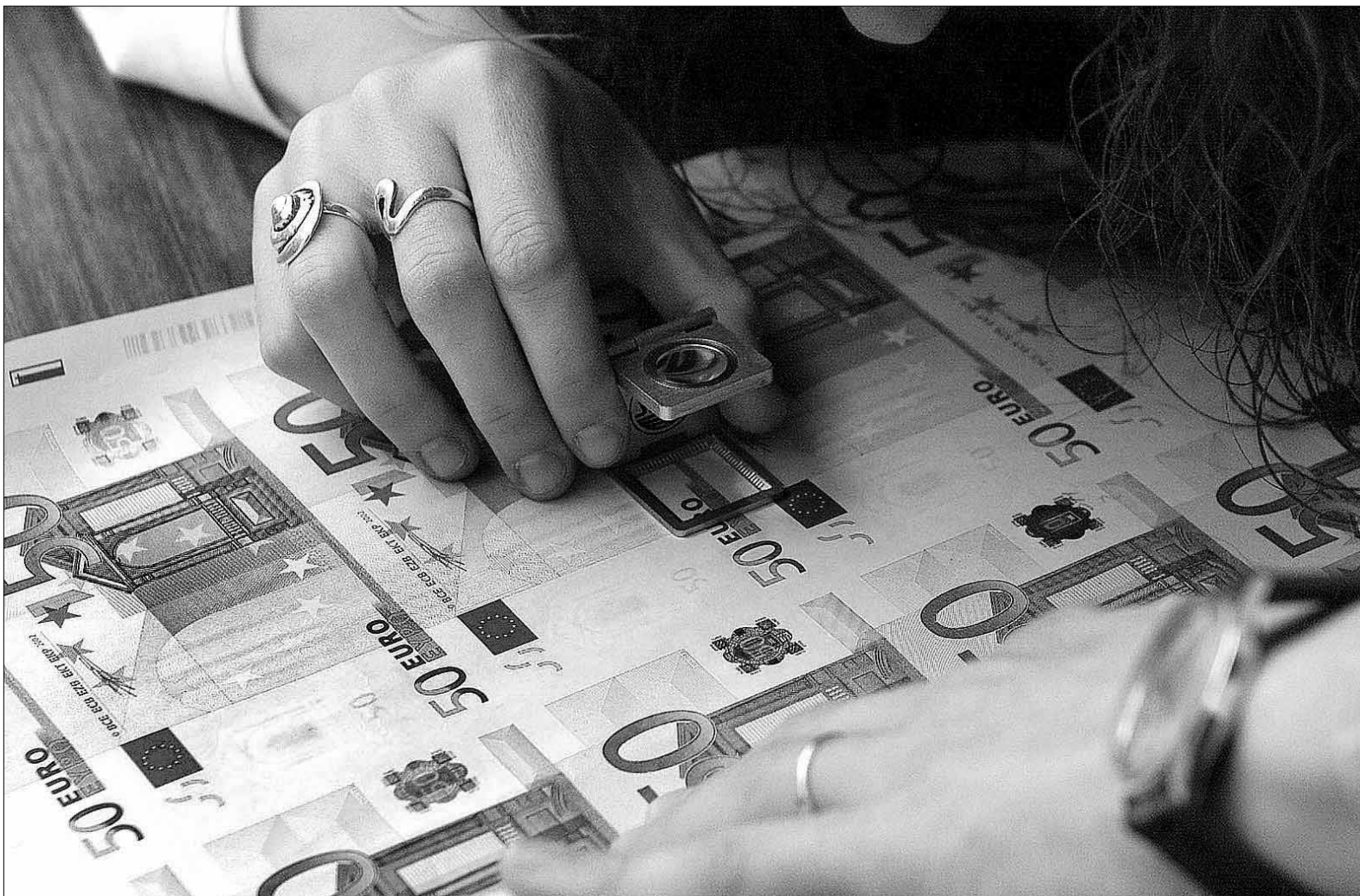
Una empleada de la Fábrica de la Moneda verifica, con un cuentahilos, la trama de una serie de billetes de 50 euros. / ALBERTO RODRIGO
