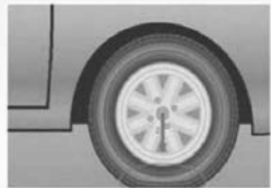
Mayor deformación de los flancos = mayor calentamiento del neumático
