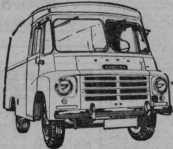
"LDO-5" Equipado con MOTOR DIESEL BMC (2. 2) POTENCIA 56 CV. • 3500 vueltas. Puertas correderizas laterales y posteriores totalmente abatibles. CAPACIDAD de carga 1,5 TONELADAS
