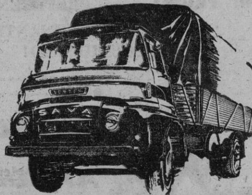
"A-504" Equipado con MOTOR DIESEL BMC (5. 1) POTENCIA 107 CV. • 2600 vueltas CAPACIDAD de carga 6 TONELADAS
