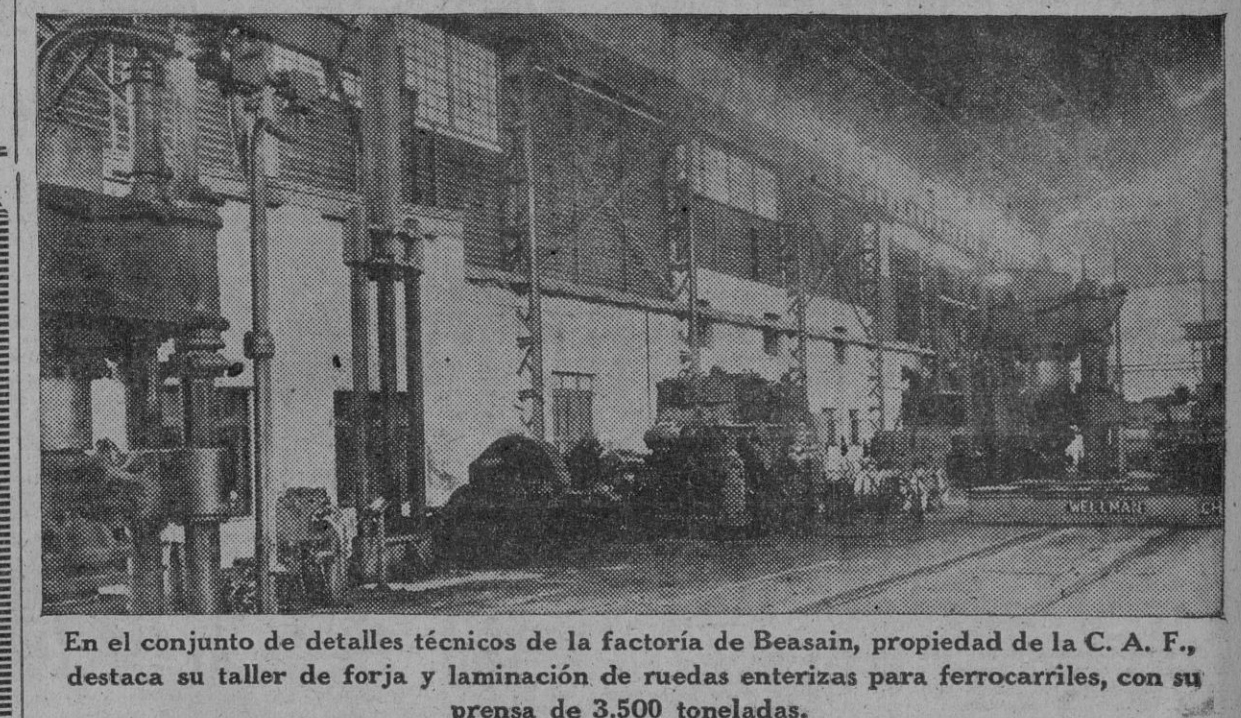
En el conjunto de detalles técnicos de la factoría de Beasain, propiedad de la C. A. F., destaca su taller de forja y laminación de ruedas enterizas para ferrocarriles, con su prensa de 3.500 toneladas.
