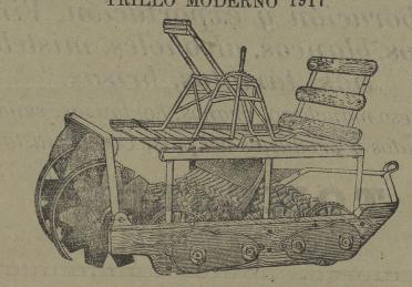
Mucho rendimiento Unico que trabaja con mies húmeda Lleva cuatro cilindros; que trabajan á diferentes velocidades Cada eje va provisto de un engrasador automático ES EL MEJOR TRILLO
