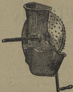
Esta desgranadora es de hierro fundido, de unos cinco kilos de peso. Lleva dos bridas para sujetarla a una mesa o tablero cualquiera, y es movida por un volante. Un niño puede emplearse en la faena de desgranar maíz, y sin gran fatiga obtendrá un rendimiento superior al que pudiera obtenerse con máquinas de más peso y de mayor coste.
