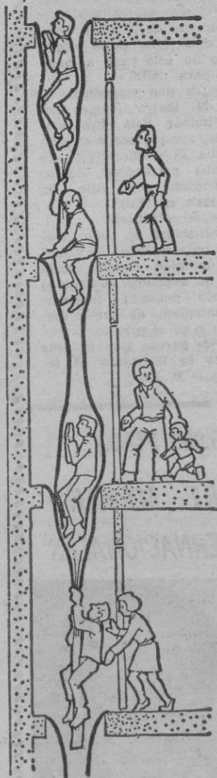
Sistema de entradas múltiples. Precisa una instalación fija, por el interior del edificio.
