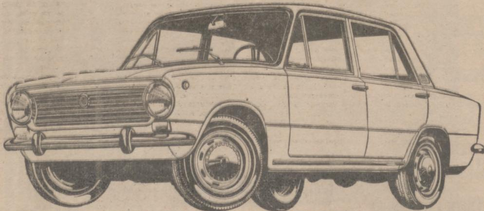
Con motor de 1.197 cm<sup>3</sup> y 65 CV-SAE. Un coche de potencia suficiente para responder en todo momento. Y seguro: el I24-D lleva doble circuito de frenos, además de los cuatro frenos de disco. Y neumáticos radiales.
