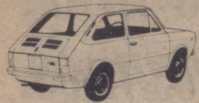
133 - GASOLINA NORMAL 843 c.c. (34 CV. DIN) 7 CV. FISCALES
