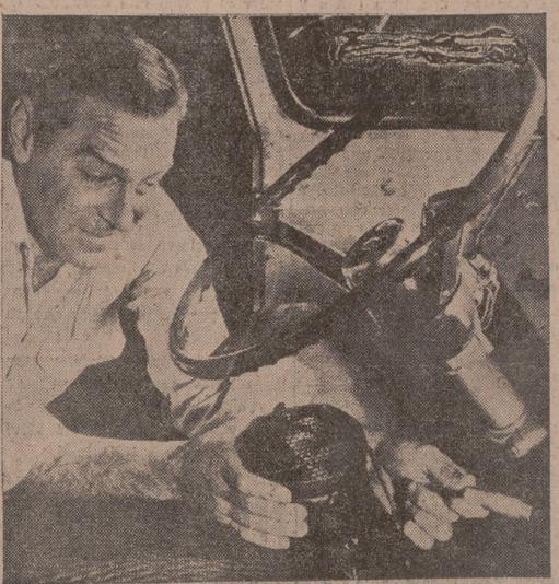
La última novedad americana en accesorios automovilísticos está constituida por el asiento refrigerado. El aparato, que en la fotografía va a ser accionado por un técnico, consta de un cojín bajo el cual se ha colocado un ventilador que forma una corriente de aire fresco entre éste y el conductor.
