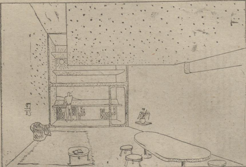
Vista del cuarto de estar y la terraza de uno de los apartamentos de la Unidad de Habitación. La zona punteada en la parte superior del dibujo es el forjado del piso que separa las dos plantas de habitaciones, de altura 2,26 metros. El living-room—al fondo en la figura—tiene altura doble, 4,80 metros, o sea la ocupada en total por las dos plantas de altura 2,26.
