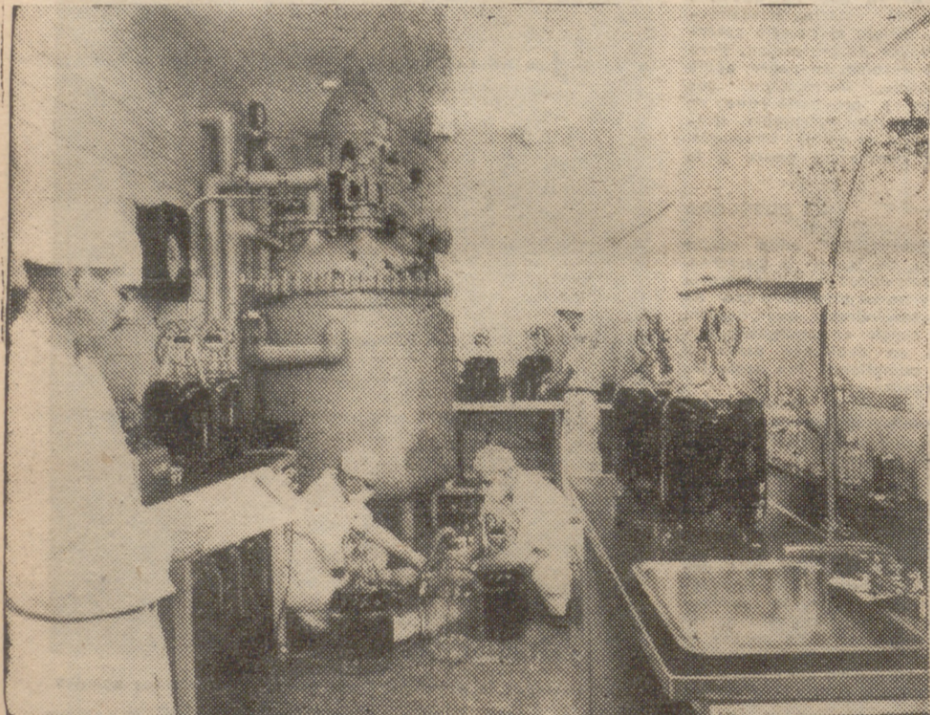
Los tres tipos de virus de la poliomielitis se cultivan separadamente, juntándolos en iguales proporciones al final de la preparación. La vacuna, una vez preparada, se conserva en grandes tanques refrigerados hasta que se valoran separadamente la potencia e inocuidad de cada lote. Los frascos conteniendo la vacuna ya valorada son enviados al Departamento de Biología para el envase final.
