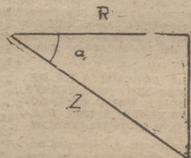
Triángulo de resistencias
