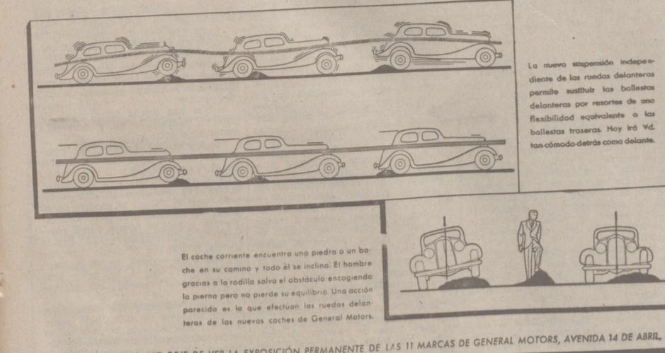
La nueva suspensión independiente de las ruedas delanteras permite sustituir las ballestas delanteras por resortes de una flexibilidad equivalente a las ballestas traseras. Hoy irá Ud. tan cómodo detrás como delante. SI VISITA BARCELONA, NO DEJE DE VER LA EXPOSICIÓN PERMANENTE DE LAS 11 MARCAS DE GENERAL MOTORS, AVENIDA 14 DE ABRIL, 550. GENERAL MOTORS PENINSULAR S.A. - BARCELONA
