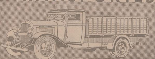
CHEVROLET.- Tres chasis. El de 4 mts. entre ejes, 2 1/2 toneladas de carga útil, ballestas auxiliares, ruedas gemelas con neumáticos 32 x 6 reforzados, Ptas. 10.950
