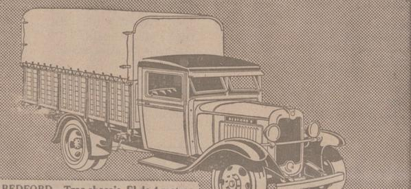
BEDFORD.- Tres chasis. El de 4 metros entre ejes, 2,3/4 toneladas de carga útil, puente trasero flotante, ruedas gemelas, Ptas. 11.800
