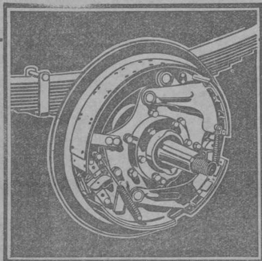
Sección de un freno delantero
