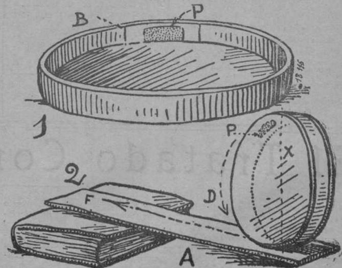
Coged una cajita redonda, de unos veinte centímetros de diámetro. En un punto de los bordes (P) pegad un pedazo de plomo plano, y cubred todo el ruedo con una banda de papel para disimular.
