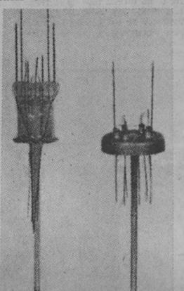
Fig. 4. Conductores de conexión a los electrodos en una válvula de vidrio y otra de metal
