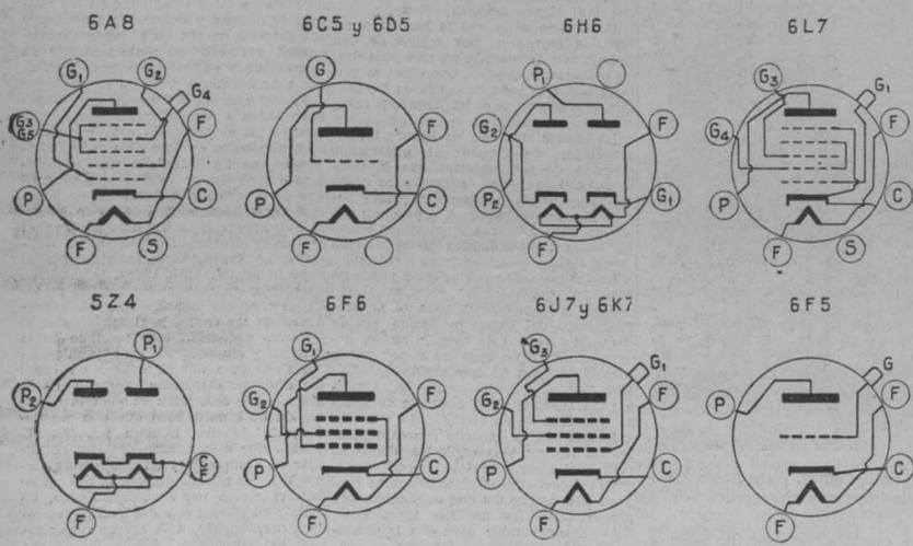
Fig. 1. Esquemas y conexiones al casquillo de los diez tipos de válvulas metálicas lanzados al mercado
