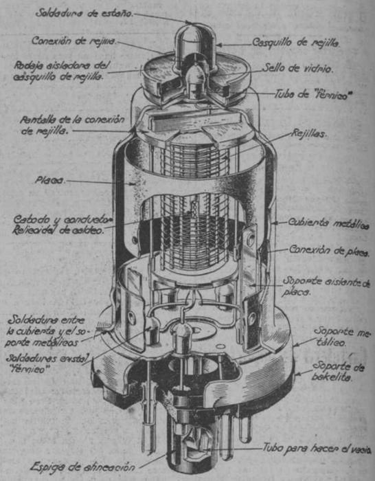
Fig. 2. Corte de una válvula de metal, en tamaño aumentado
