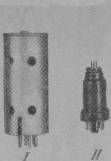
Fig. 5. I. Válvula de cristal, con su pantalla.—II. Válvula de metal equivalente
