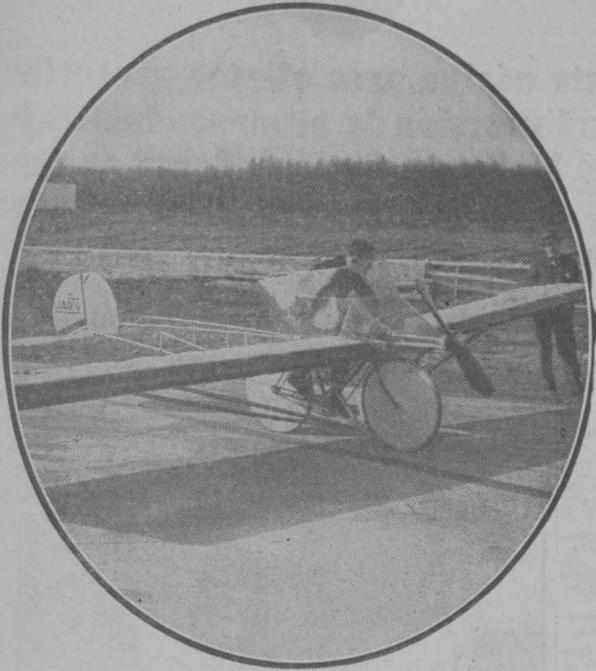
Cuando la tendencia en los voladores es a suprimir las alas, en los móviles de tierra lo es a tenerlas; y, así, en Montlhéry, se han hecho ensayos de una bicicleta con alas que ha alcanzado la velocidad de 25 kilómetros por hora
