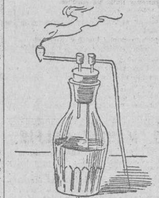
Finalmente, con un tercer corcho, perforado del mismo modo, se forma un sifón aplicando uno de los orificios al tubo largo e insertando en el agujero lateral un tercer tubo de vidrio, acodado como en la figura puede verse.
