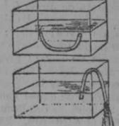
jas que subirán á la superficie del líquido. Cuando cesen de salir las burbujas se saca al exterior el extremo obturado con el corcho, dejándolo colgar sobre el borde del depósito, mientras el otro extremo queda bajo el nivel del líquido.
