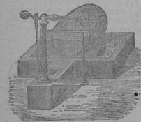
Puente Bascu a vinicola.-Nuevo sistema de caja metálica. colocándose à flor de tierra para facilitar el pesado de los toneles colocados encima en cualquier sentido.
