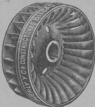
Rueda turbina «Francis»
