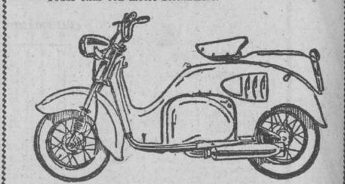
"ISO-SCOOTER". La moto ideal para nuestra provincia, por su sección de rueda, 125 c. c. 2 cilindros, 6,7 HP, 70 kilómetros de velocidad, 2,5 litros de consumo a los 100 kms.
