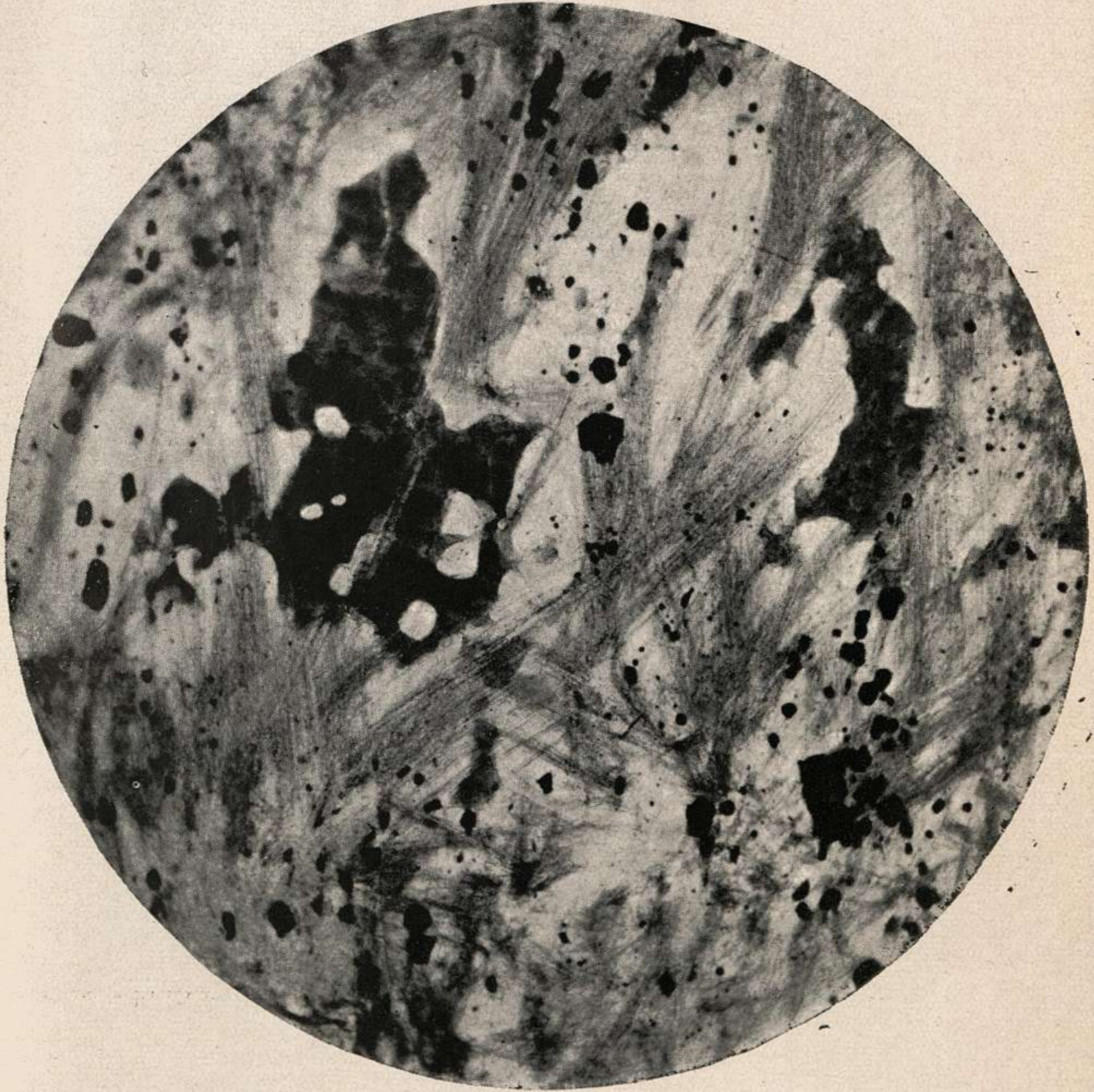
Agulhas finas de silimanita atravessam os grãos redondos de quartzo e, também, as palhetas de biotita. Os pequenos grãos pretos são magnetita.
