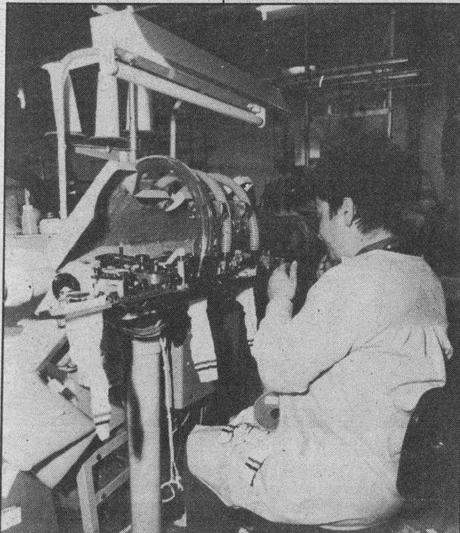
Maquinaria de planchado de calcetines.
