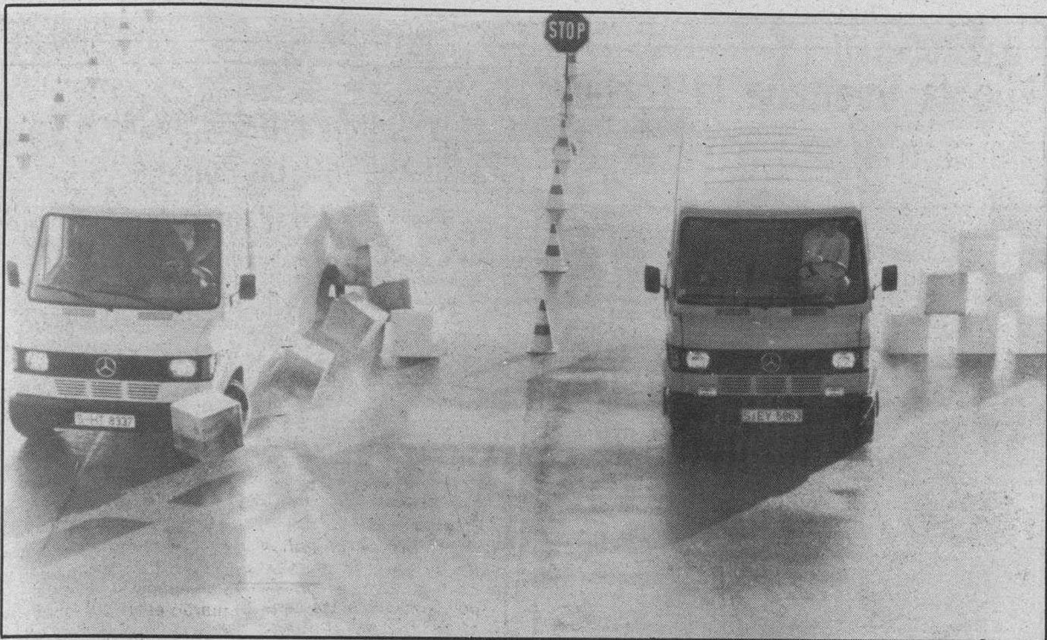
Sistema antibloqueo de furgonetas. — La industria motriz Daimler-Benz AG, de Stuttgart (República Federal de Alemania), presenta en la Exposición Internacional del Automóvil el sistema antibloqueo «ABS» para furgonetas. Este sistema de seguridad permite frenar y conducir al mismo tiempo sobre calzadas resbaladizas. En la imagen fotográfica, tomada durante las pruebas efectuadas con el nuevo sistema «ABS», vemos que la furgoneta de la izquierda, cuyas ruedas han resultado bloqueadas al frenar el conductor sobre la pista helada, se ha llevado por delante el muro artificial, mientras que el conductor de la otra furgoneta, equipada con el sistema antibloqueo «ABS», por contra, no ha perdido el control del volante a pesar de que también ha utilizado el freno. Foto did/Daimler-Benz AG.
