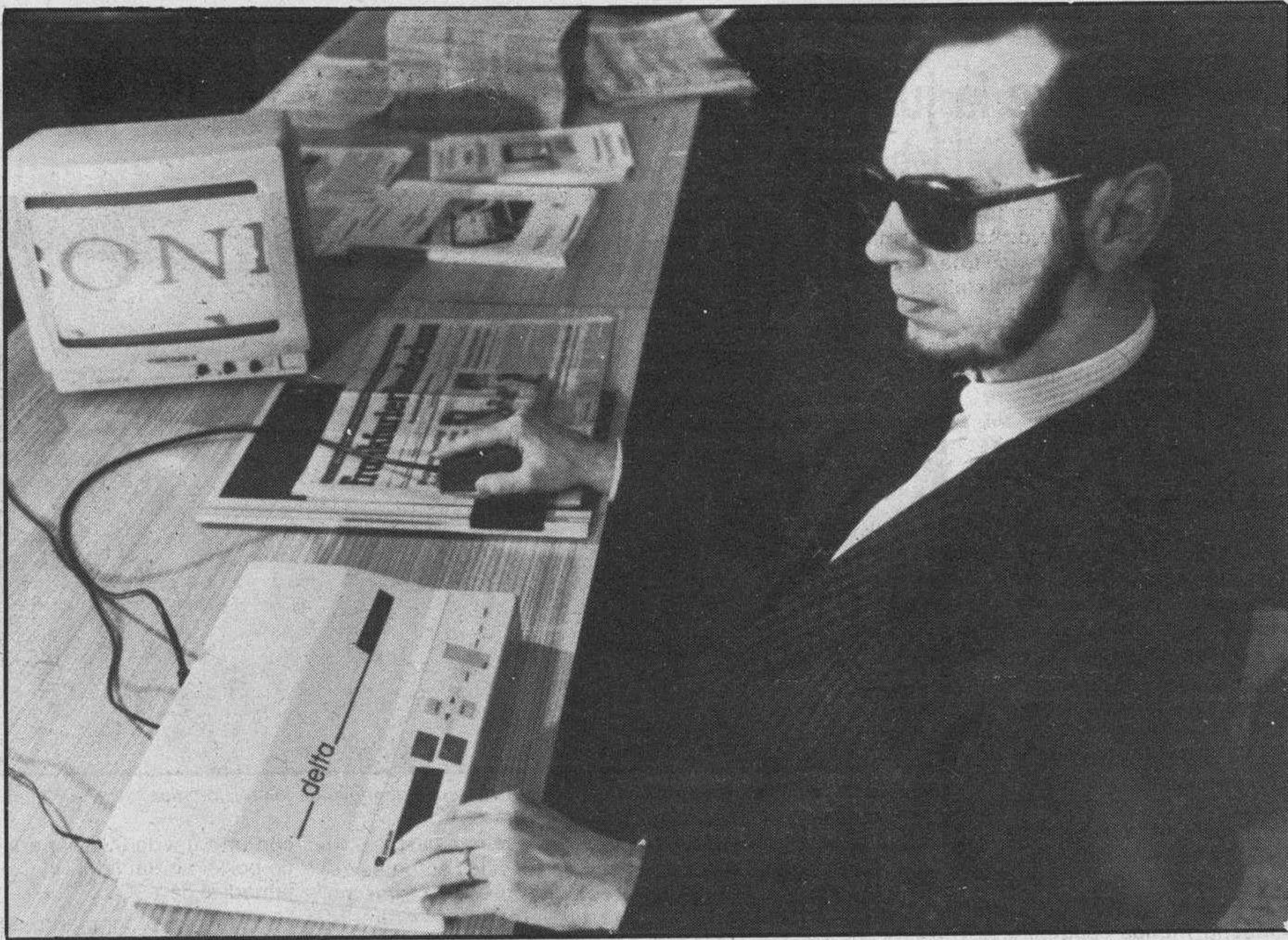
Nuevo aparato de lectura para ciegos. — En Hamburgo acaba de presentarse un nuevo aparato de lectura, cuya moderna electrónica permite que un texto leído con una cámara manual sea transmitido directamente a la escritura Braille. De esta forma los ciegos ya no dependen exclusivamente de publicaciones especiales para ciegos, sino que pueden «leer» sin ayuda ajena publicaciones «normales», por ejemplo, periódicos y libros, ante todo también cartas personales o informaciones.
