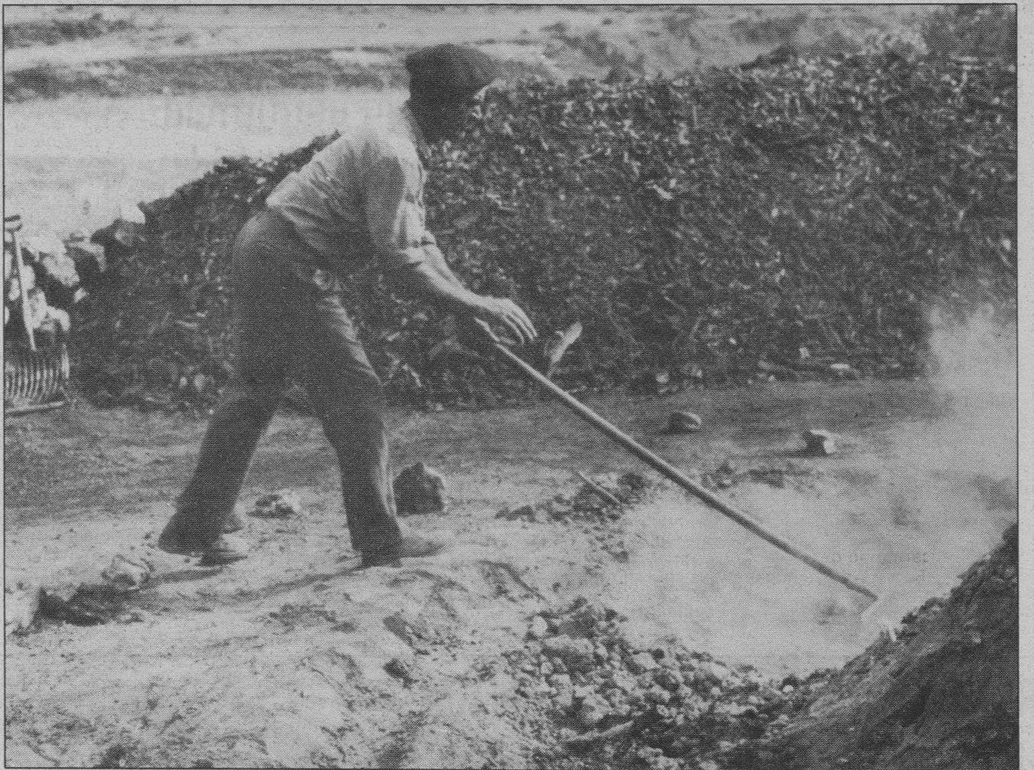
Carboneros. — En algunas zonas de la provincia aún se utilizan viejos métodos para la obtención de carbón vegetal. Cortar la madera, apilarla con tierra y esperar que la combustión lenta haga el resto. La tradición se conserva en las tierras altas, en las zonas montañosas, donde los bosques son cuidados con esmero, pues en ellos radica un medio de vida que todavía no se ha perdido. F. Pedro Antonio.
