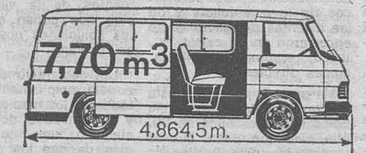
chasis tubular soporta una carrocería de 4,86 m con una distancia entre ejes de 2,75 m para disponer de mayor superficie de carga, y por lo tanto de mayor volumen, hasta un máximo de 9,6 m³ en la versión de techo elevado.
